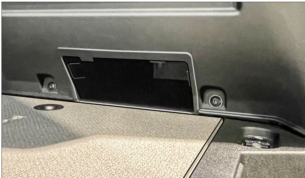
Fabriksmonterad originalvägg med långlastöppning.
