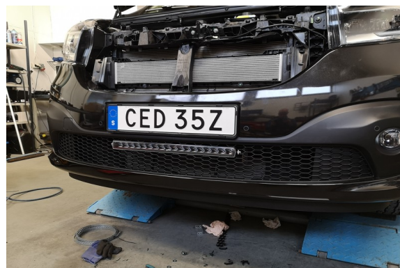
Provmontera ljusramp och grill, justera om nödvändigt och slutdra sedan.
