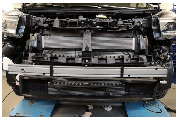
Montera ihop ljusramp och fästena, och häng över balken för att bedöma var hål i gummiskyddet skall tas upp i nästa steg.
