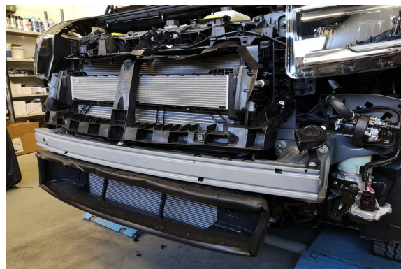
Lossa plastkonsollen som sitter framför krockbalken, sitter med 2 torx skruv framtill.
