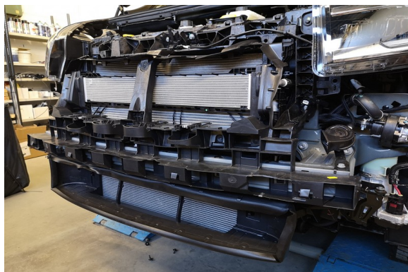
Demontera hela fronten.
