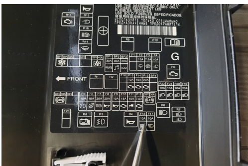
Helljussignal för aktivering av extraljusrelät kan tas från säkring F18.
