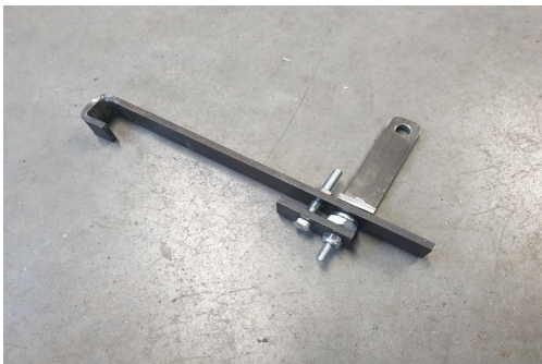
Ett av de två fästena som kläms runt krockbalken.
