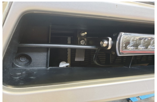
Monterat fäste och ljusramp sett utifrån.
